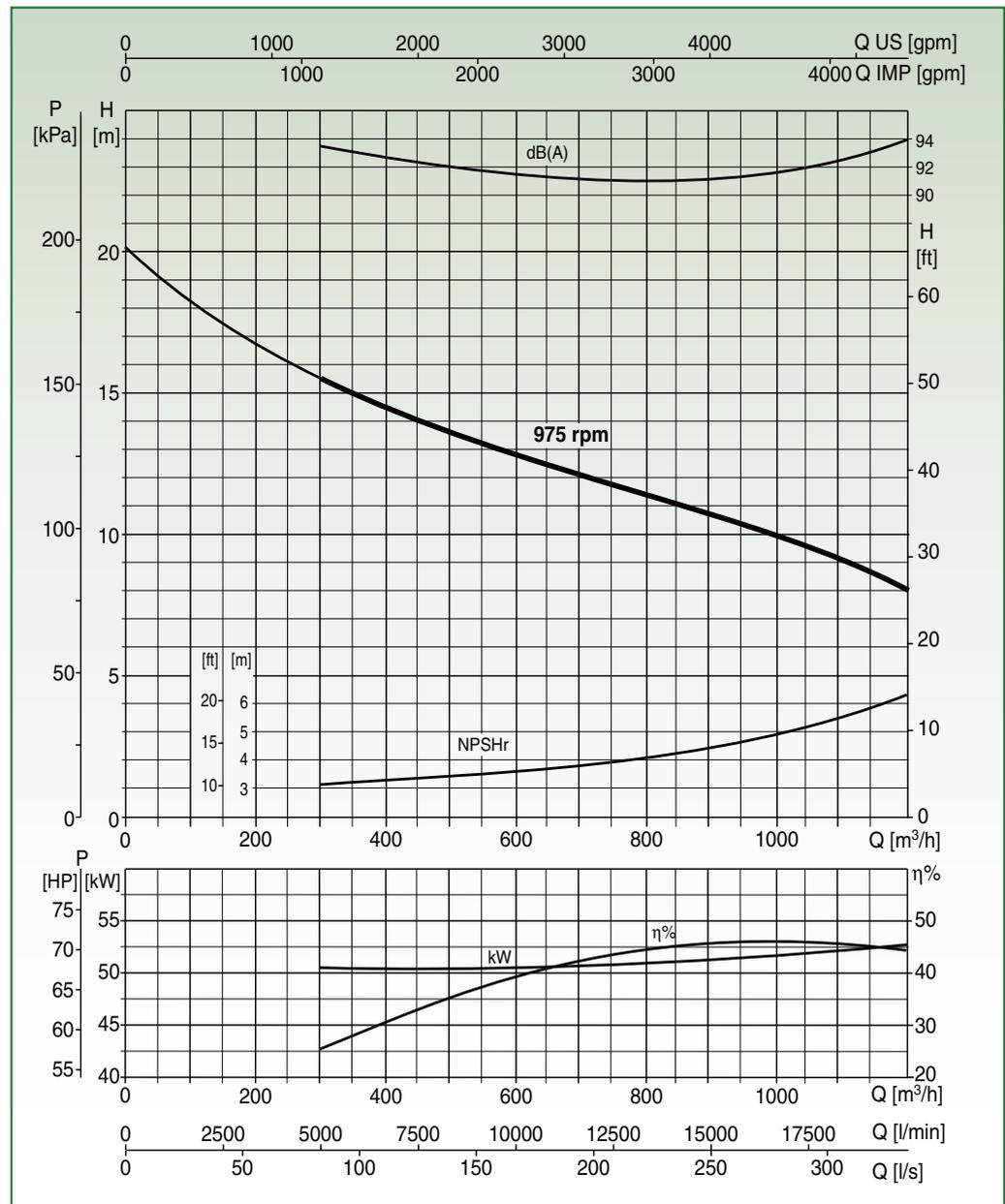
Collaudo a norma UNI EN ISO 9906 livello 2 - Liquido di prova: acqua ( $\rho = 1000 \text{ kg/m}^3$ )
